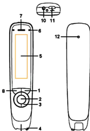
1. **Botón Encendido/Apagado y Atrás:** Presiona durante 3 segundos para apagar o encender el dispositivo. Presiona brevemente para usar como la función Cancelar en la interfaz del usuario
