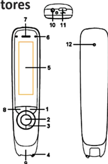
1. **Botão On/Off & Regressar:** Prima durante 3 segundos para ligar ou desligar o dispositivo. Prima brevemente para utilizar como uma função de cancelar na interface do utilizador
