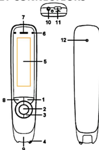
1. **Bouton On/Off et de retour:** Appuyez pendant 3 secondes pour allumer ou éteindre l'appareil. Appuyez brièvement pour l'utiliser comme fonction d'annulation dans l'interface utilisateur
