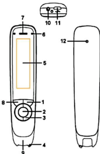
1. **Aan-/uit- en terug-knop:** Druk 3 seconden in om het apparaat aan of uit te zetten. Druk kort om als annuleerfunctie te gebruiken in de gebruikersinterface
