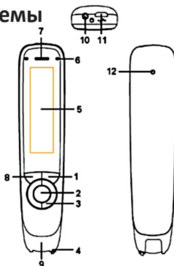
1. **Кнопка «Вкл/Выкл» и «Назад».** Нажмите и удерживайте 3 секунды, чтобы включить или выключить устройство. Краткое нажатие действует как функция отмены в пользовательском интерфейсе.
