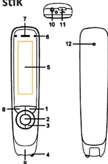
1. **Tænd/sluk og tilbageknap:** Tryk i 3 sekunder for at tænde eller slukke enheden. Foretag et kort tryk for at bruge den som en annuller-funktion i brugergrænsefladen.
