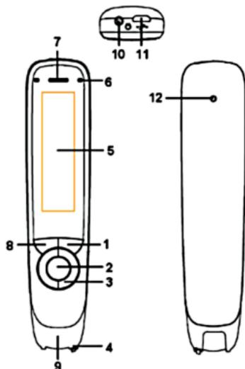
1. **PÅ- och AV-knapp:** För att slå på och stänga av enheten, tryck på strömknappen och håll nedtryckt i 3 s. Tryck kort på knappen för att använda den som avbrytningsfunktion i användargränssnittet
