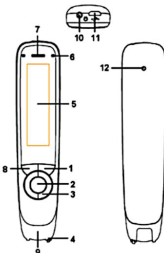
1. **Ein-/Aus- und Zurück-Taste:** 3 Sekunden gedrückt halten, um das Gerät ein- bzw. auszuschalten. Kurz drücken in der Benutzeroberfläche als Abbrechen-Funktion.
