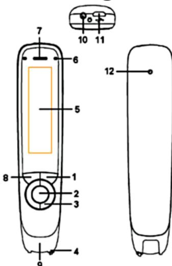
1. **Aan-/uit- en terug-knop:** Druk 3 seconden in om het apparaat aan of uit te zetten. Druk kort om als annuleerfunctie te gebruiken in de gebruikersinterface
