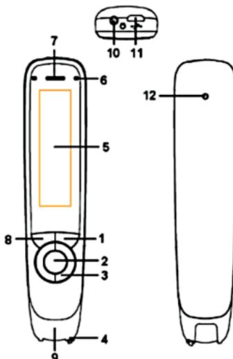
1. **PÅ- och AV-knapp:** För att slå på och stänga av enheten, tryck på strömknappen och håll nedtryckt i 3 s. Tryck kort på knappen för att använda den som avbrytningsfunktion i användargränssnittet
