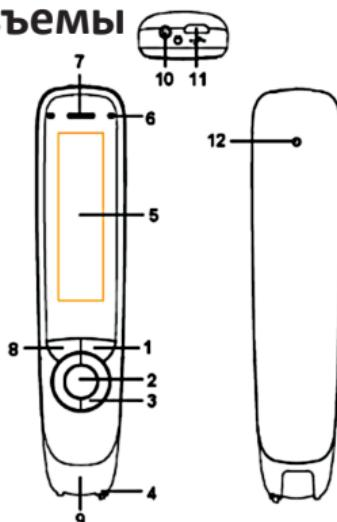
1. **Кнопка «Вкл/Выкл» и «Назад».** Нажмите и удерживайте 3 секунды, чтобы включить или выключить устройство. Краткое нажатие действует как функция отмены в пользовательском интерфейсе.
