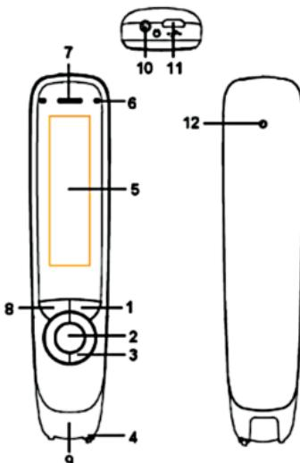
1. **Bouton On/Off et de retour:** Appuyez pendant 3 secondes pour allumer ou éteindre l'appareil. Appuyez brièvement pour l'utiliser comme fonction d'annulation dans l'interface utilisateur
