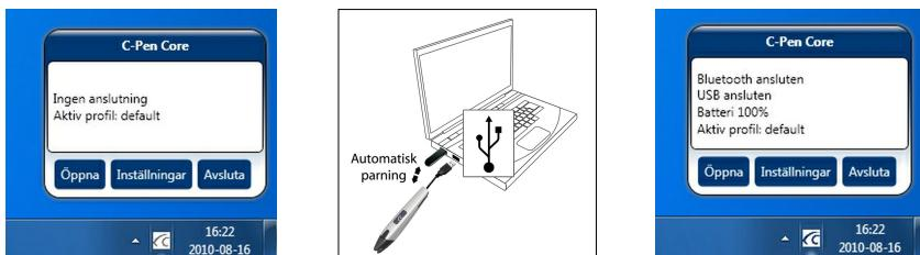
Anslut C-Pen till din dator via den medföljande USB-kabeln under de inledande inställningarna. C-Pen Core-mjukvaran parar automatiskt C-Pen med din dator.
