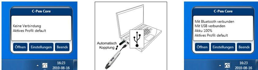
Verbinden Sie bei der Erstinstallation den C-Pen über das mitgelieferte USB-Kabel mit Ihrem Computer. Der C-Pen-Core-Software verbindet automatisch den C-Pen mit dem Computer via Bluetooth.
