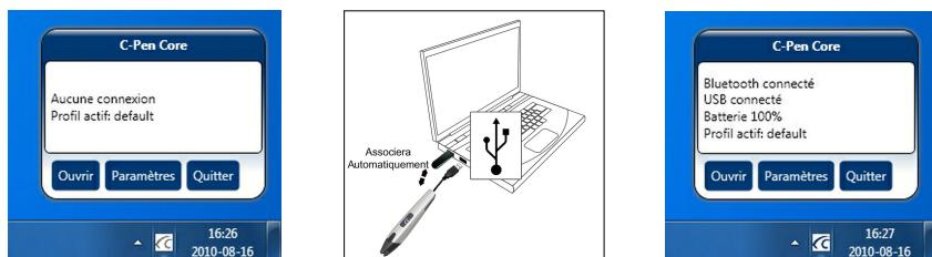
Lors de la première installation, connectez le C-Pen à votre ordinateur via le câble USB fourni. Le logiciel C-Pen Core se connecte automatiquement le C-Pen avec votre ordinateur via Bluetooth.
