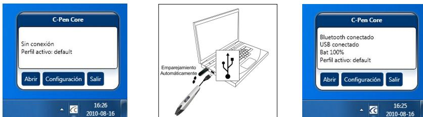
Conecte C-Pen a su equipo mediante el cable USB incluido durante la configuración inicial. El software C-Pen Core se conectará automáticamente el C-Pen con el ordenador a través de Bluetooth.
