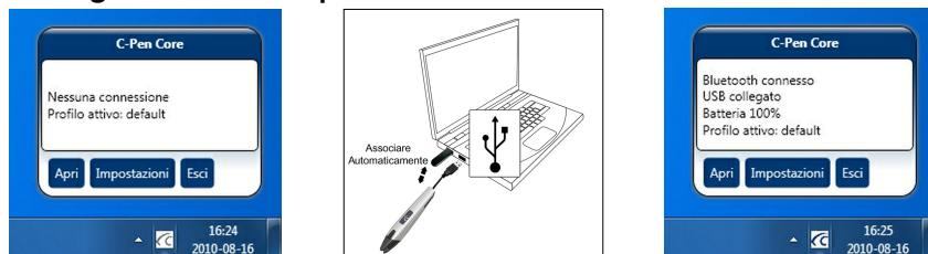
Per eseguire la configurazione iniziale, collegare C-Pen al computer utilizzando il cavo USB incluso nella confezione. Il software C-Pen Core si collega automaticamente al C-Pen con il computer via Bluetooth.
